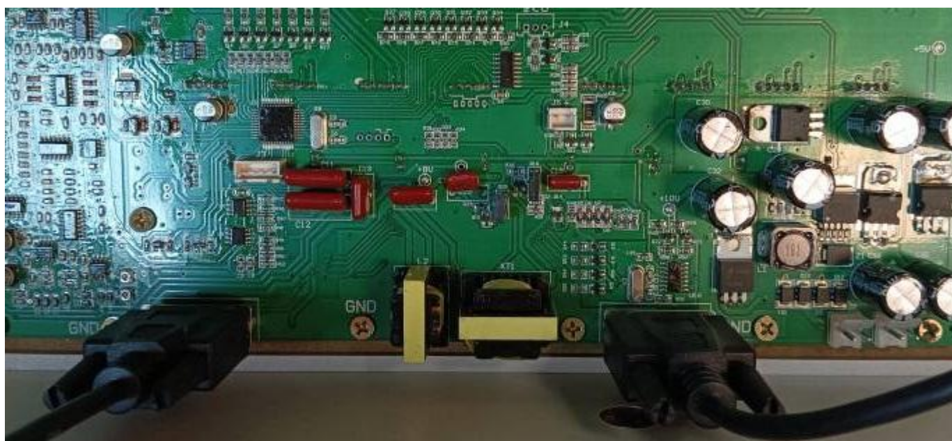
Подключение разъемов на системной плате (рис.2)
